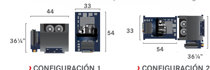
Módulo de estación de llenado que muestra el carrete de manguera opcional
